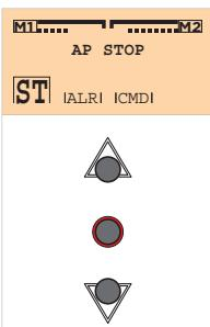
Cuando se activa un dispositivo de seguridad, la sección **SIC** muestra la indicación del dispositivo de seguridad activado (ya sea desde la tecla **ST** del teclado o desde la caja de conexiones F70/IPU36)
