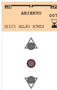
En posición de apertura completa, si el cierre automático está habilitado y no bloqueado, aparece el icono del reloj de arena intermitente con la indicación de los segundos que faltan al inicio del cierre (segundos que quedan de pausa).
