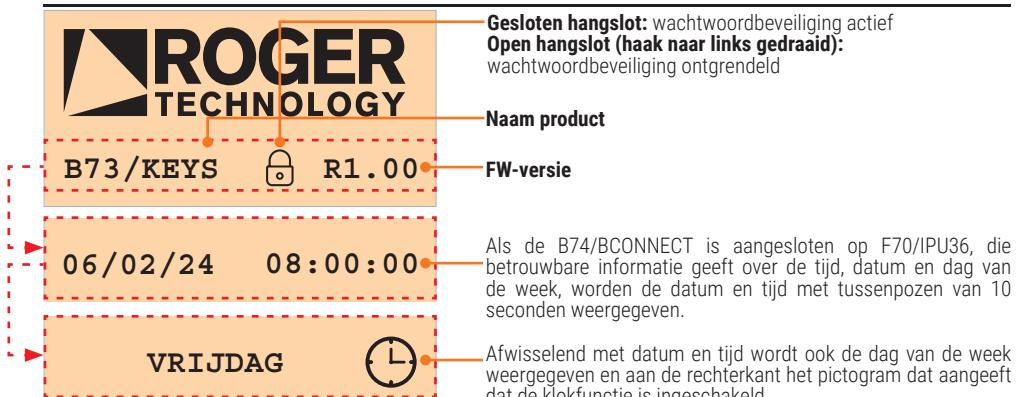
Bij inschakeling toont het display het startscherf gedurende 3 seconden en gaat het vervolgens naar het operationele scherm dat de status van de automatisering aangeeft.
