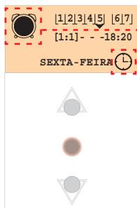
Se a função RELÓGIO/TEMPORIZADOR tiver sido inibida por um comando dado pela tecla CH nas B73/KEYS (se quiser fechar mais cedo do que o previsto pelo relógio) ou por comandos para o terminal IPU, se o par B0 na IPU estiver definido como 0 I, o ícone do relógio escurece como mostrado na figura.
