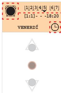
Se la funzione OROLOGIO/TIMER è stata inibita da un comando dato da tasto CH su B73/KEYS (se si vuole chiudere anticipatamente rispetto a quanto previsto dall'orologio) oppure da comandi a morsettiera IPU, nel caso in cui par.B0 su IPU sia impostato a 0 I allora l'icona dell'orologio si annerisce come da figura.
