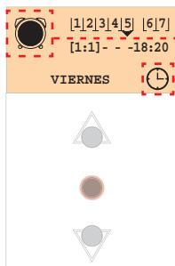
Si la función de RELOJ/TEMPORIZADOR ha sido inhibida por un comando dado por el botón CH en B73/KEYS (si se desea cerrar antes de lo previsto por el reloj) o por comandos de caja de conexiones IPU, en el caso de que el par  $B0$  en IPU esté establecido en  $\square$ , el ícono del reloj se vuelve negro como se muestra en la figura.
